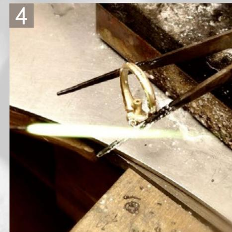
4 Es folgt der heikelste Arbeitsschritt der Produktion. Die zusammengeführte Ringschiene wird nun unterhalb des Steines mittels konventionellem Lötverfahren (offene Flamme) dauerhaft verbunden. Das nahe Löten am Stein kann unter Umständen den Diamanten beschädigen oder zerstören. Ungefähr jeder hundertste Diamant wird dabei beschädigt.
