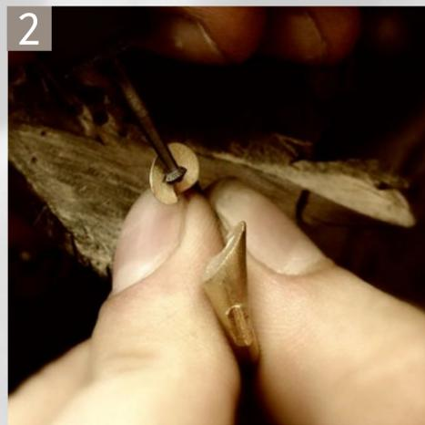
2 Die Ringschiene ist nun bereit die Seele des Schmuckstückes in Empfang zu nehmen – den Diamanten. Vorsichtig werden in den Spiegelflächen exakt bemessene Einkerbung vorgenommen, in denen später die Rundiste des Diamanten ruhen wird. Jeder Fehler bei diesem Arbeitsschritt führt unweigerlich zur Zerstörung des Ringes.
