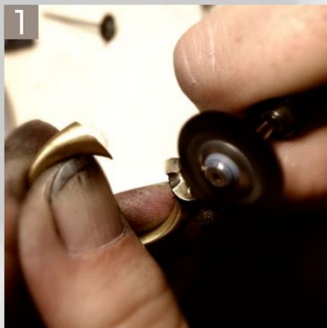
1 Die Spiegelflächen der noch geöffneten Ringschiene erhalten in aufwendigen Politurvorgängen ihr Hochglanzfinish. Dieser Arbeitsschritt ist zu keinem anderen Zeitpunkt möglich, nur so kann sichergestellt werden, dass später der Diamant von allen Seiten von spiegelnden Flächen umgeben ist.
